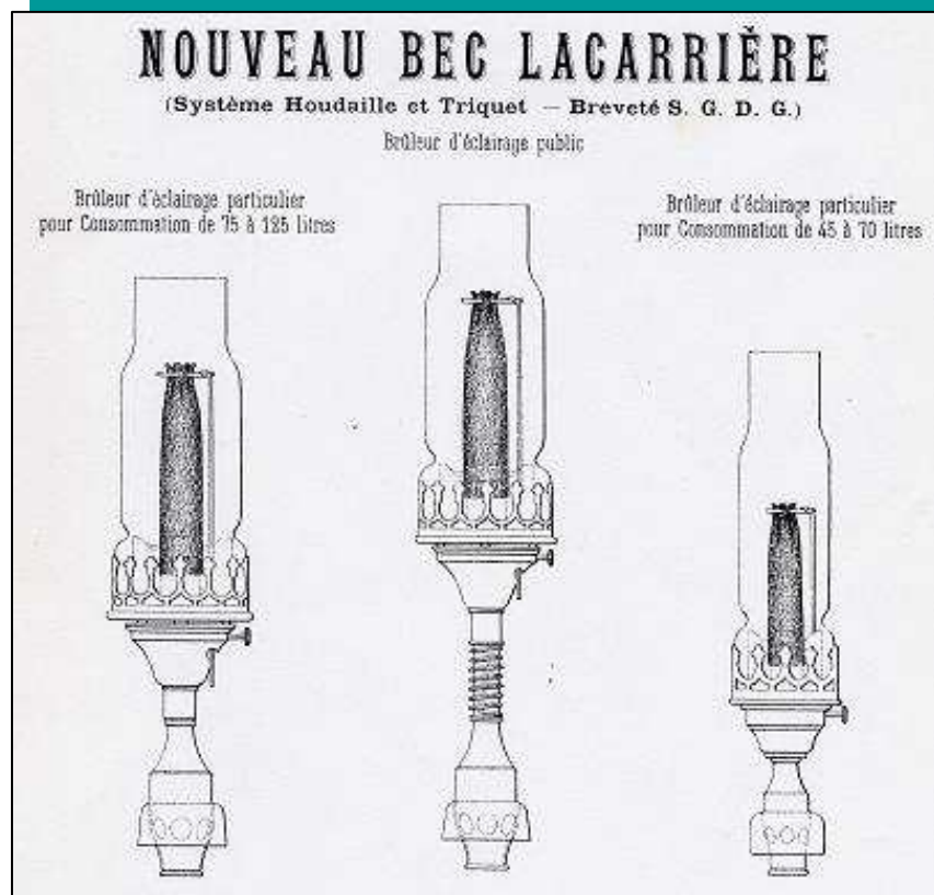
Le bec Houdaille-Triquet développé par Lacarrière et utilisant des verres produits par l'usine de Choisy-le-Roi
